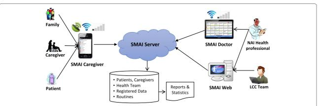
Fig. 2 SMAI overall structure. NAI: Care Center for the Elderly (*Núcleo de Atenção ao Idoso*); LCC: Computer Science Laboratory (*Laboratório de Ciência da Computação*); SMAI Caregiver, SMAI Doctor and SMAI Web: applications that compose SMAI
